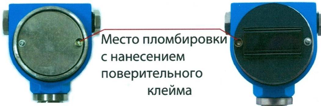
Рисунок 4 – Схема пломбировки от несанкционированного доступа,
